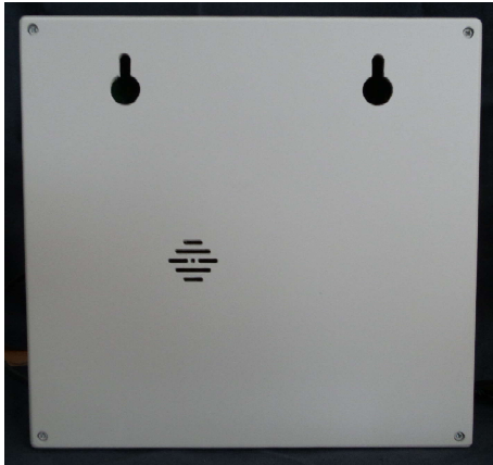
ภาพด้านหลัง มีรูน็อตและช่องเสียง Buzzer
