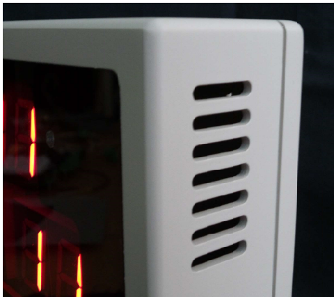
ช่องระบายอากาศ
