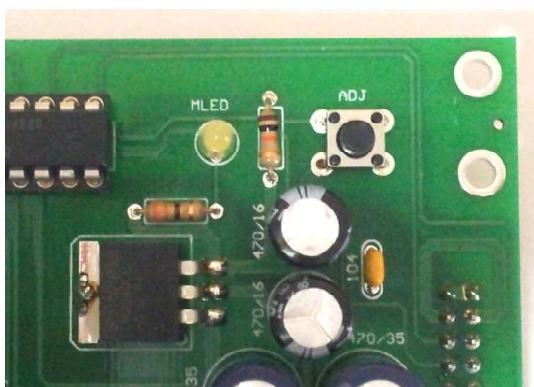
บอร์ดควบคุมมี LED และปุ่ม Adj ด้วย
