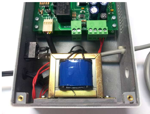
ภาพหม้อแปลงภายใน
