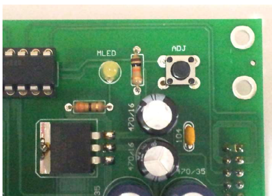
บอร์ดควบคุมมี LED และปุ่ม Adj ดัดย
