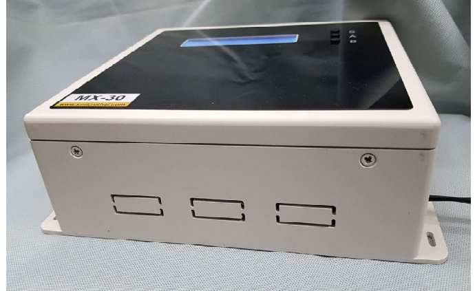
ด้านล่างมี Option ทำเป็นปลั๊ก สำหรับ Relay 1,2,3 ได้
