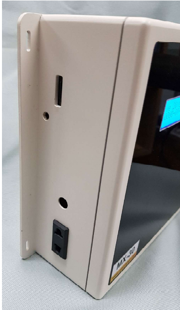
ด้านข้างมีช่องเสียบ Micro-SD-Card, Jack เสียงออก, รูดอดสาย และปลั๊กสำหรับเครื่องขยายเสียง
