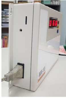
ช่องเสียบ Micro-SD-Card และ Jack Audio Out รวมทั้งปลั๊กสำหรับเครื่องขยายเสียง
