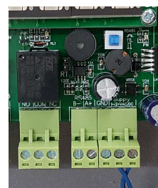
บริเวณขั้ว Relay และ RS485 พอร์ตสื่อสาร
