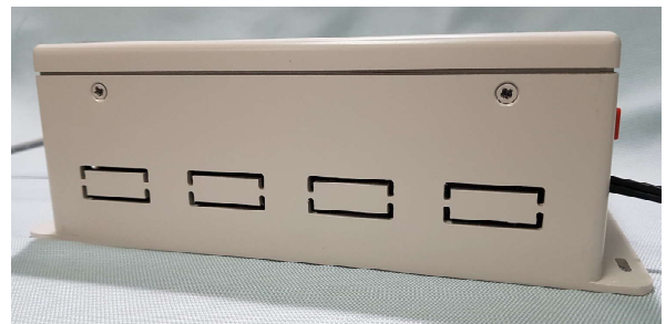
เคสรองรับการทำให้เป็นปลั๊กตัวเมียได้ 4 ช่อง
